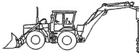
Esempio di terna con trivella
